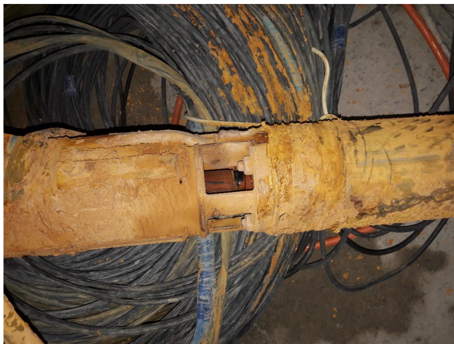
Сурет 3.1 – Сораптың механикалық қоспалармен ластануы
