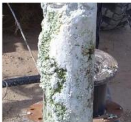
Рисунок 1 – Погружной насосный агрегат поднятый со скважины с наростами химических осадкообразований
