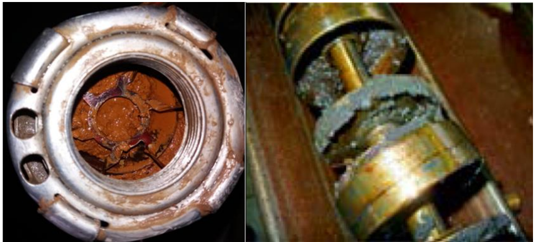
Сурет 3.10 - Сораптың ағынды бөлігінің механикалық қоспалармен ластануы
