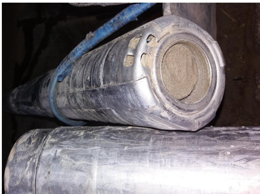
Сурет 3.2 – Сораптың жұмыс органдарының механикалық қоспалармен ластануы
