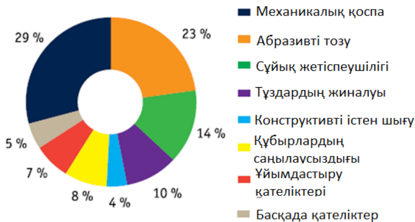
Сурет 3.9 Ортадан тепкіш ортадан тепкіш электросорапты қондырғының істен шығу себептері
