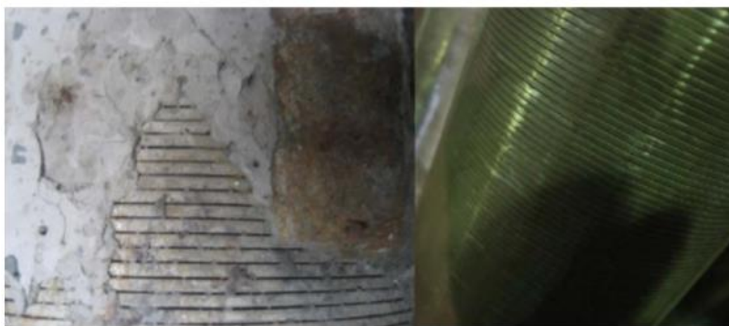
Сурет 3.5 – ЖНШ сүзгісінің пайдаланудан кейінгі техникалық қалпы жаңа сүзгімен салыстыруы
