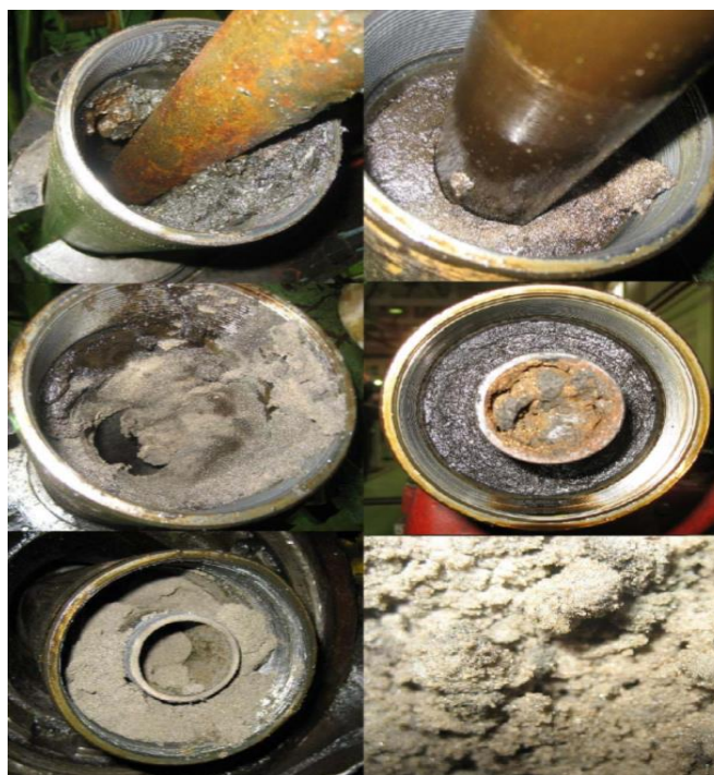
Сурет 3.4 – Механикалық қоспалары бар батырылатын сепараторлардың демонтаждан кейінгі қалпы
