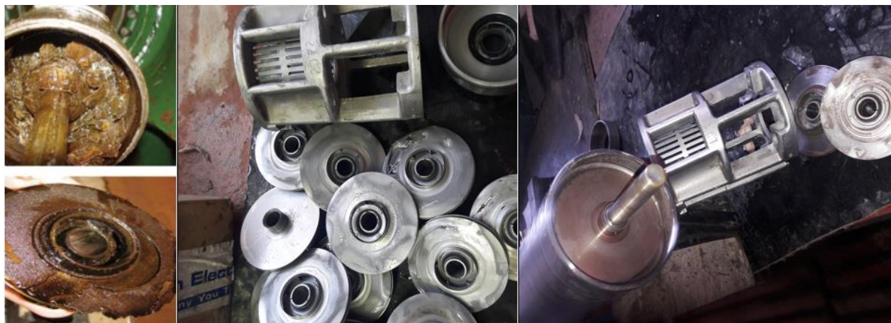
Сурет 3.8 – Ортадан тепкіш сораптың жұмыс дөңгелектерінің ластануы мен тозуы
